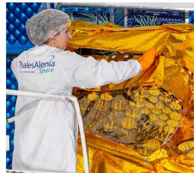
Camille est en chambre anéchoïque où elle fait la mesure de performances électromagnétiques d'une antenne en champ proche.
